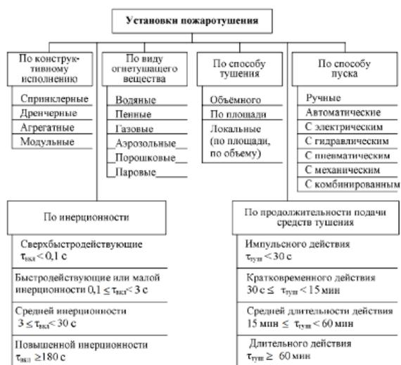
Рис. 2. Классификация установок пожаротушения
