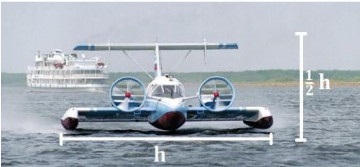
Рис. 3.  $h$  - размах крыла; высота зоны действия эффекта экрана - половина размаха и ниже
