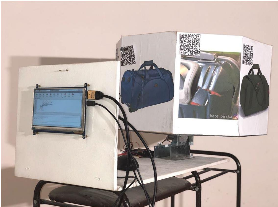
Рис. 1. Система машинного зрения по контролю багажа в аэропорту
